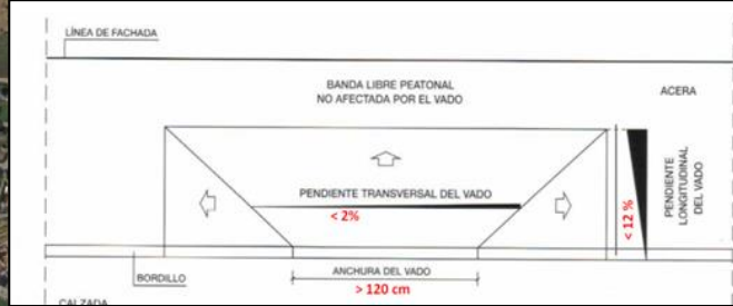
Críters de disseny d'un pas de vianants accessible d'acord amb VIV /561/2010
